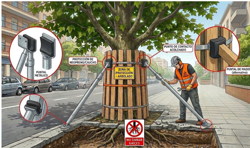
Ilustración 1. Anclaje del árbol con puntales rígidos para su estabilización durante la fase de obras
