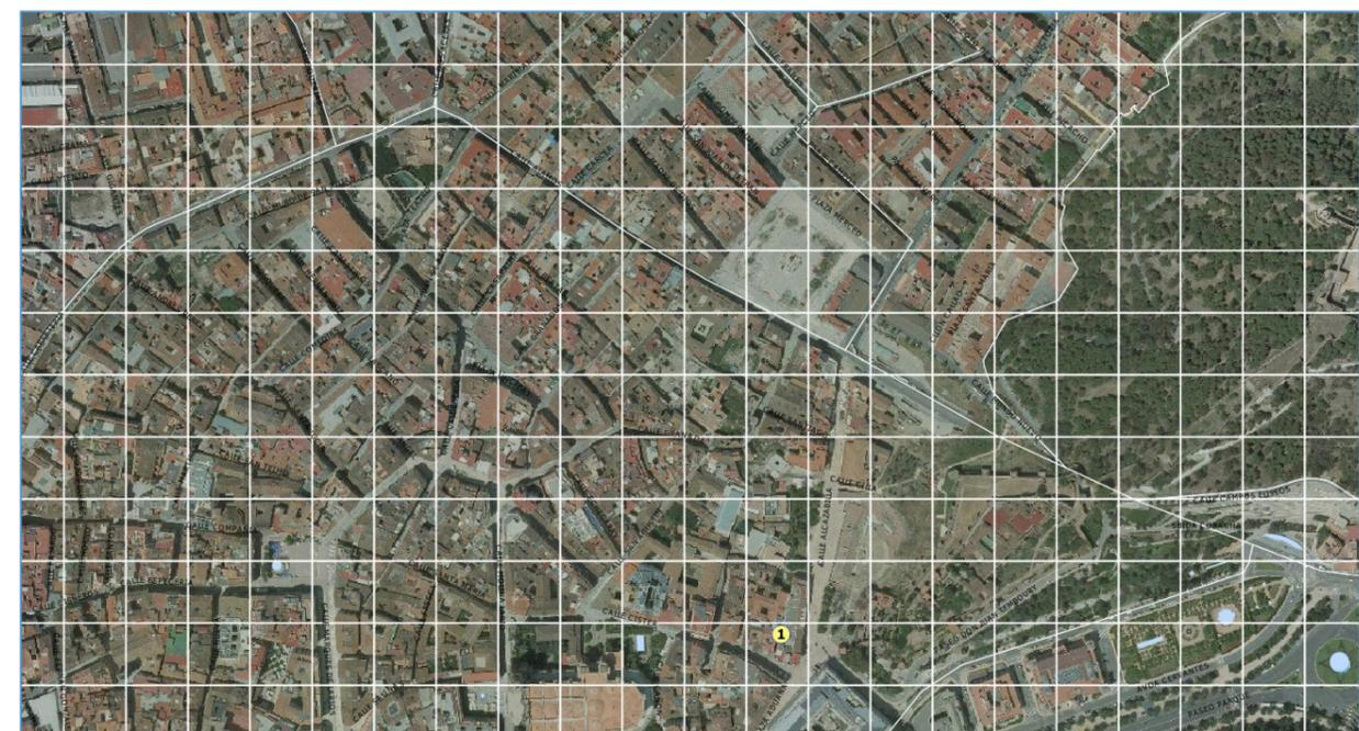
Figura 13 - Vista general (figura superior) y detalle (figura inferior) del mallado del municipio en celdas de 50 x 50 metros
