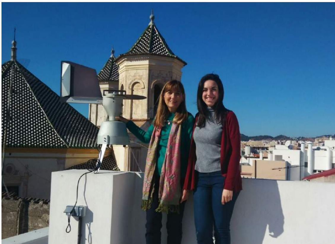
Figura 1. Captador de polen de tipo Hirst, situado en la terraza del edificio de calle Dos Aceras.
