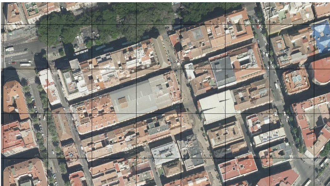
Figura 4 Discretización de la zona de estudio en celdas de 50x50 m.
